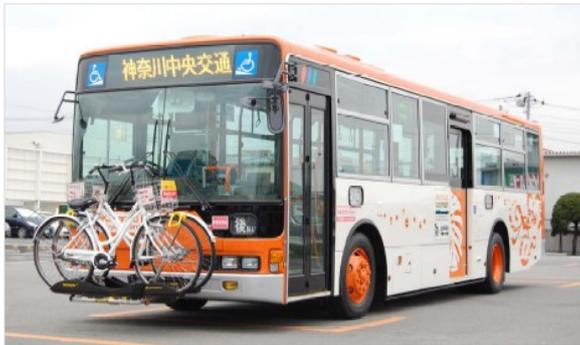
導入するのは、湘南海岸に並行して整備されているサイクリングロード沿線にあるJR茅ヶ崎駅ー同辻堂駅間など4路線6台で、1台につき自転車2台をバスの前面に積載。バスの前面にラックを設置するのは、日本で初めてという。自転車の積み下ろしは乗客自身で行う。実験中、6月1日以降は別途100円を徴収する予定。
