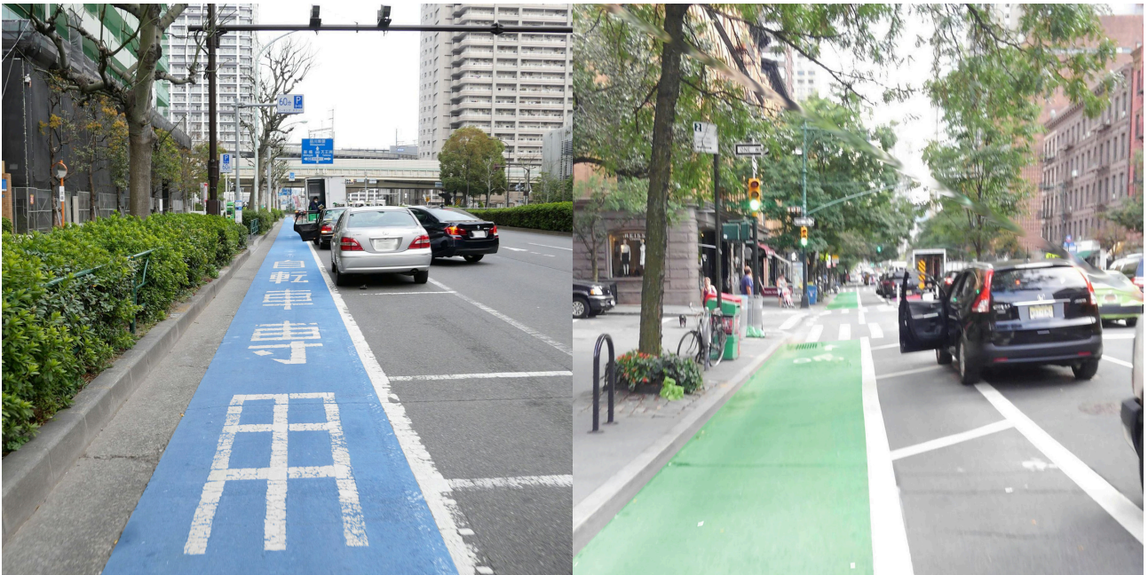
左：都道480号の自転車レーン 右：緩衝帯を備えたニューヨークの自転車レーン
